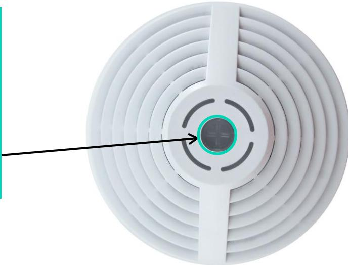
2. Способ ОТАА. После нажатия на кнопку запуска, устройство осуществит три попытки присоединения к сети в заданном при настройке частотном плане. При получении подтверждения активации в сети LoRaWAN, устройство подаст сигнал индикатором (свечение в течение 5 секунд) и перейдет в режим «Активный». Если все попытки окажутся неудачными, датчик продолжит накопление данных и будет осуществлять попытки присоединения к сети раз в 6 часов.
